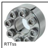
RTTss Frette de serrage non autocentrante, Couple moyen/élevé
