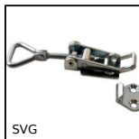
SVG Grenouillère rigide réglable, Course de 106,7mm à 121,4mm
