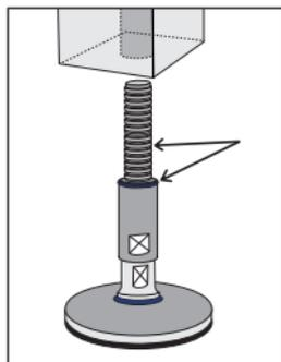
Graisser le joint et le filetage avec de la graisse alimentaire
