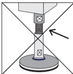
Le filetage doit être entièrement recouvert par la douille
