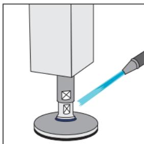
Rinçage 8-12 bars (max 100°C) Inclinaison à 45° du jet à 300 mm mini. pour ne pas endommager les joints
