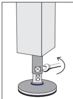
Visser la douille afin de mettre en contact le joint supérieur avec le bas de la machine
