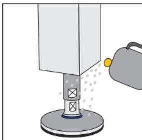
Appliquer le détergent Alcalin (température max. 90°C) et laisser agir 10 min
