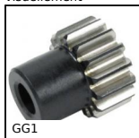
GG1 Engrenage droit denture rectifiée, Acier traité
