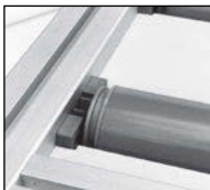
Utilisation comme support de rouleau de convoyage
