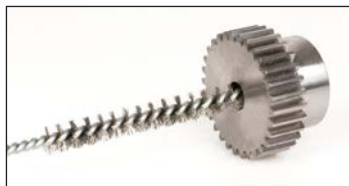
Ebavurrage de l'alésage d'un engrenage
