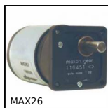
Motoréducteur 12V et 24V DC, de 0,075 à 0,6Nm
