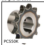
PCS50K Pignon à chaîne alésé rainuré, 12,7mm (DIN08B-1)
