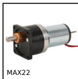
MAX22 Motoréducteur 12V et 24V DC, de 0,07 à 0,2Nm
