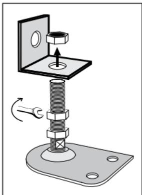
Régler la hauteur du pied à l'aide d'un écrou / contre écrou (non fourni)
