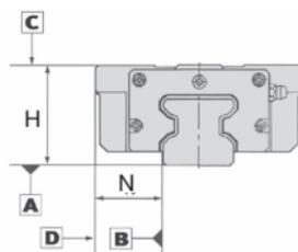
Note<sup>(1)</sup> : La variation dimensionnelle sur la cote H représente la variation de dimension entre des patins montés sur un même rail lorsque la dimension H est mesurée à la même position sur le rail.
