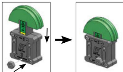
Pré-contraindre le tendeur grâce au bouton de précharge.
