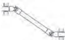
Pour obtenir un mouvement uniforme (homocinétique), les deux angles doivent être égaux et dans le même plan
