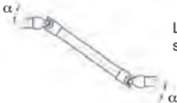
Les arbres d'entrées et de sortie doivent être parallèles
