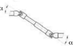
Les arbres doivent être guidés par des paliers ou des roulements au plus près du joint de cardan afin de réduire les charges radiales.
