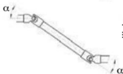
Les arbres d'entrées et de sortie doivent être parallèles
