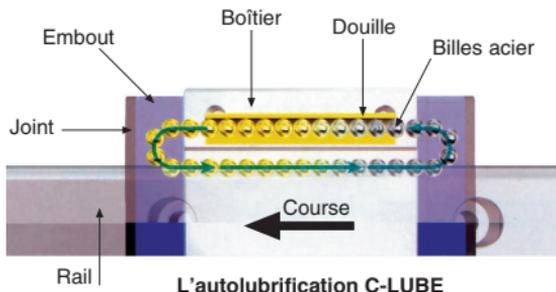
En circulant dans le patin, les billes en acier passent dans la douille C-LUBE, se chargent en lubrifiant et le déposent sur les éléments roulants.
